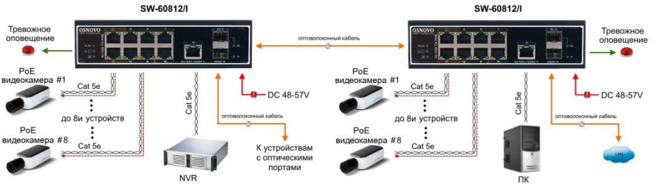
Рис.5 Схема каскадного подключения коммутатора SW-60812/I
